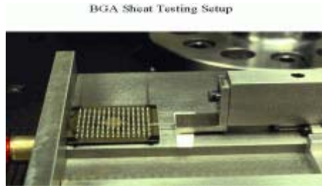
圖十. BGA 錫球強度測試設定圖
